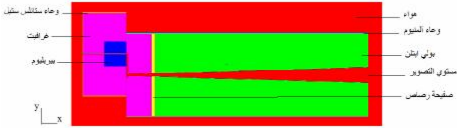
الشكل (11) مقطع أفقي في المستوي x-y لمنظومة التصوير بالنترونات الحرارية في المسرع السوري باستخدام الكود MCNP5-BETA.
